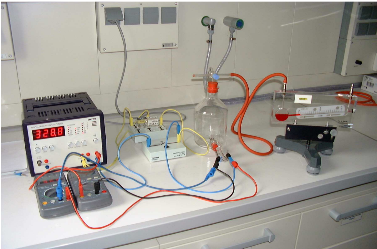
Abb.2: Versuchsanordnung für die Bestimmung von c_v
